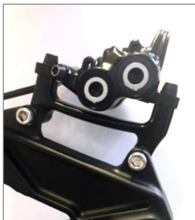
Position Bremsadapter für Laufrad 29"
