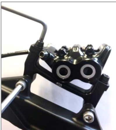
Position Bremsadapter für Laufrad 27,5"
