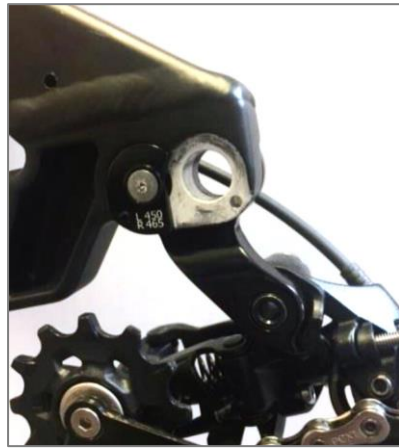
Position Flip-Chip für Laufrad 29"
