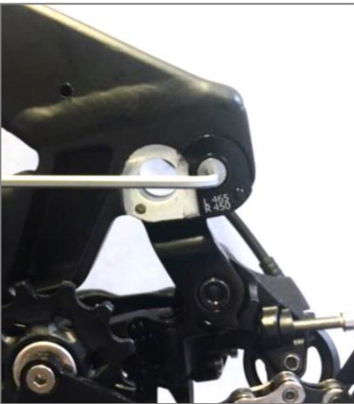
Position Flip-Chip für Laufrad 27,5"
