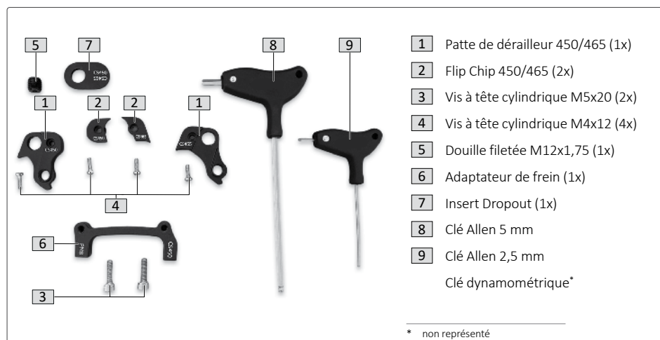
Fig. 20 : Aperçu des pièces et outils nécessaires
