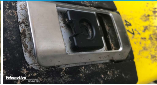
Mit diesem Hebel wird der Akku vom Rahmen getrennt
